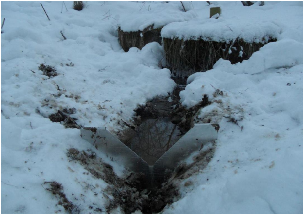
Kuva 2. Lähteen virtaamamittaus, taustalla lähteeseen asennetut kaivonrenkaat.
